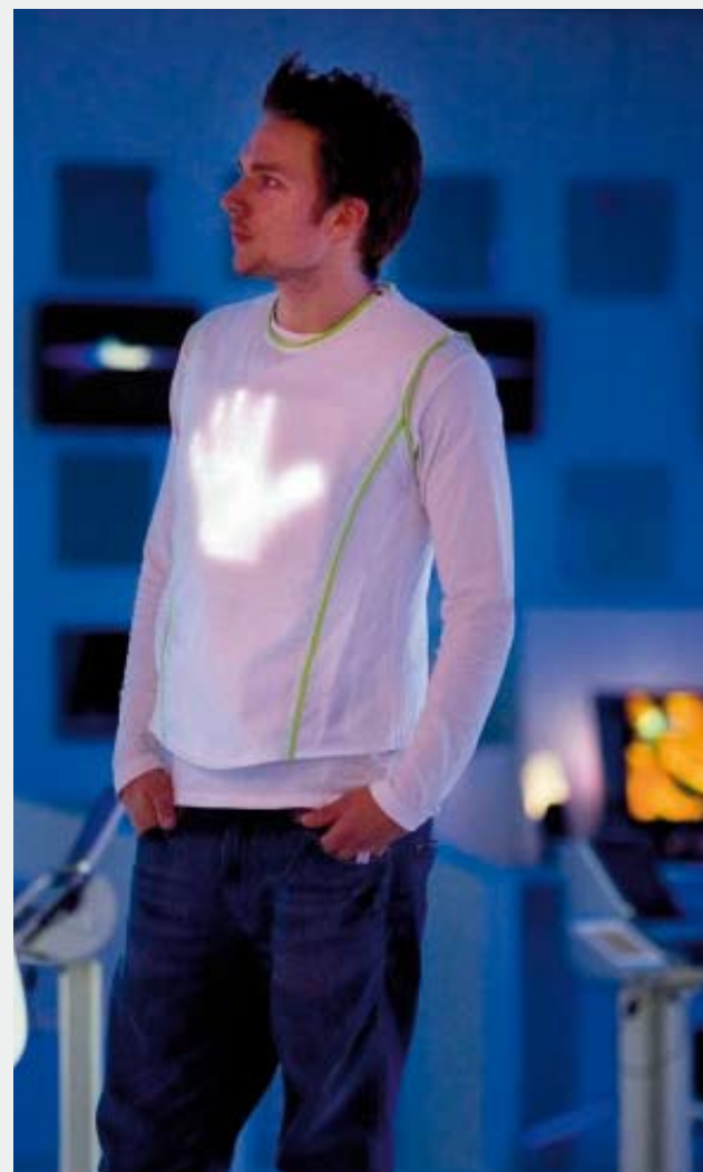
Stoffdesign kan knapt bli mer futuristisk enn Lumalive - lysende høyteknologiske tekstiler som kan brukes i møbler, interiører og klær. Flerfargede lysende dioder (LED) er integrert i stoffet, samtidig som materialets funksjonelle mykhet og fleksibilitet ivaretas. En fantastisk designinnovasjon for de av oss som fort går lei av statiske møbler og objekter og har behov for hyppig fornyelse. Det er Philips som står bak underverket. www.lumalive.com
